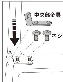
②中央部金具と冷蔵室ドア側の金具穴の凹凸を合わせます。
