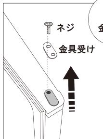
⑦冷凍室ドアの底面左側に金具受けを取り付けます。
