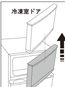
⑥冷凍室ドアの底面右側のネジを外し、金具受けを取り外します。
