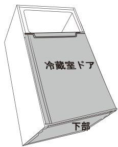
②スパナもしくはプラスドライバーを使ってネジ（2本）を外し、下部金具を取り外します。
