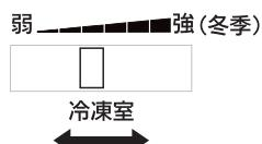
冷凍室と冷蔵室の冷気の配分を調節します。
