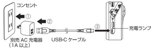
※充電が始まると、状態表示画面に「5.0」と表示され、バッテリーマークが右図の順に表示され、充電ランプが点滅します。
