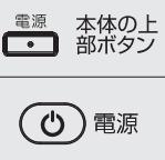
1 「電源」ランプ表示が赤色に点灯しているときは待機状態です。リモコンの【電源】または本体の上部【電源】ボタンを押します。
