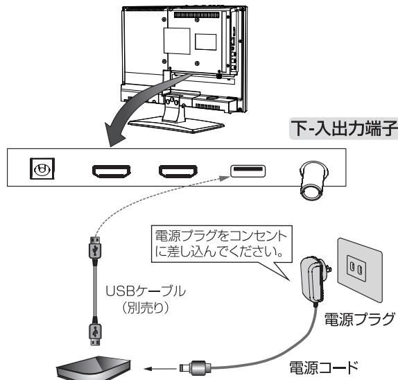
※電源供給のハードディスク推奨使用。(標準規格-USB2.0)
