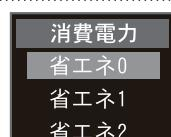
※省エネ1：バックライトの明るさを抑え、バックライトの消費電力を約15%～20%節約することができます。
