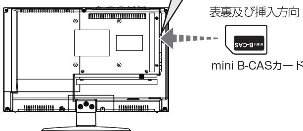
※テレビ本体のB-CASカードスロットに、図の方向で挿入します。(奥まで確実に挿入してください。)
